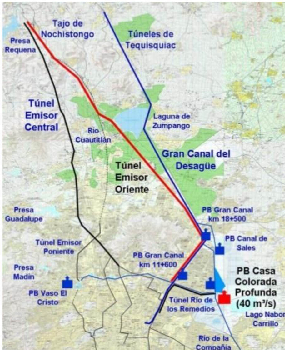
Ilustración 1 Sistema de Drenaje Profundo de la CDMX
